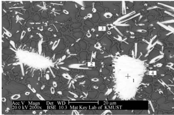
图 4 S 2 试样熔覆层 SEM 微观组织形貌
